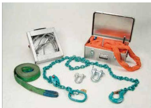
Lasten sind möglichst doppelt anzuschlagen, wobei geeignete Anschlagpunkte zu wählen sind und der Anschlag- oder Spreizwinkel nicht größer als  $60^\circ$  ( $120^\circ$ ) betragen soll, da hier in jedem Strang bereits die einfache Zugkraft wirkt.
