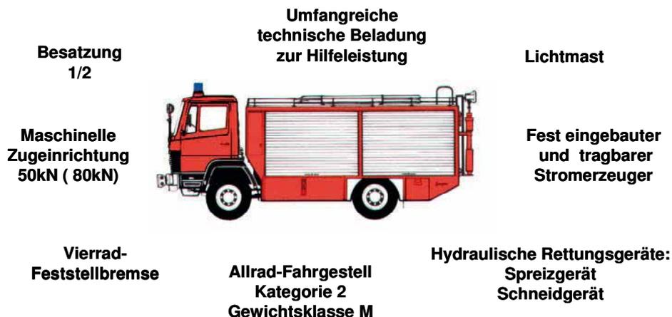
Die maschinelle Zugeinrichtung dient zum Ziehen, Bewegen und Halten von Lasten. Bei eingeschalteter Vierradfeststellbremse und vorgelegten Radkeilen kann der RW über ein Zugseil die Last bewegen. Im direkten Zug können Kräfte bis zur Nennzugkraft der Winde aufgebracht werden. Hierbei unterscheiden sich die Winden in Winden mit seillagenabhängiger Zugkraft und automatischem Zugkraftausgleich. Bei Verwendung einer (**zugelassenen**) losen Rolle kann die Zugkraft verdoppelt werden.
