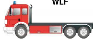
Ein Nachschubfahrzeug ist ein Feuerwehrfahrzeug zur Beförderung von Ausrüstung, Löschmitteln und sonstigen Gütern zur Versorgung einer eingesetzten Einheit.
