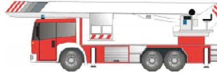
Hubarbeitsbühnen sind Feuerwehrfahrzeuge mit einer auschiebbaren Konstruktion oder einem auschiebbaren Aufbau mit Rettungskorb bestehend aus einem oder mehreren starren oder teleskopierbaren, gelenkartigen Mechanismen oder einer Kombination dieser Möglichkeiten in Form von Auslegern und / oder Leitern. Die Hubeinrichtung darf schwenkbar auf dem Untergestell montiert sein.
