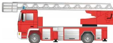
Drehleitern sind Feuerwehrfahrzeuge mit einer ausschiebbarer Konstruktion oder einem ausschiebbarer Aufbau in Form einer Leiter mit oder ohne Rettungskorb. Sie sind auf dem Untergestell schwenkbar montiert.
