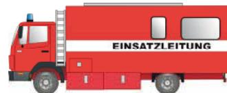
Ein Einsatzleitfahrzeug ist ein Feuerwehrfahrzeug ausgestattet mit Kommunikationsmitteln und anderer Ausrüstung zur Führung taktischer Einheiten.
