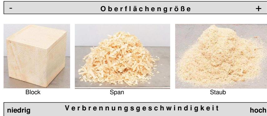
Abhängig vom Verhältnis Oberfläche zur Masse des brennbaren Stoffes läuft eine Verbrennung schneller ab, obwohl die Konzentration des umgebenden Sauerstoffes gleich bleibt.
