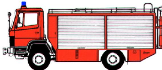
Rüst- und Gerätefahrzeuge werden zur Durchführung technischer Hilfeleistungen eingesetzt. Die Suche und Rettung von Personen, Tierrettung, Beseitigen von Unfallfolgen und Schäden durch Unwetter, Öffnen von Türen, Sicherungsmaßnahmen bei Absturz – oder Einsturzgefahren sind nur einige Einsatzbeispiele.
