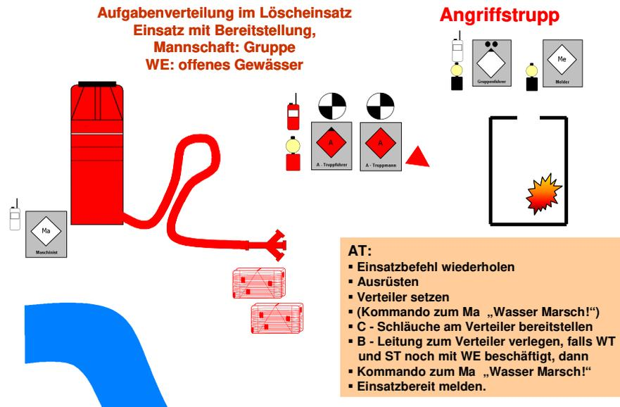
Die Wasserentnahme über Saugschläuche wird bis zwei Längen Saugschläuche vom WT hergerichtet. Werden mehr als zwei Saugschläuche benötigt, wird der Wassertrupp vom Schlauchtrupp unterstützt.
