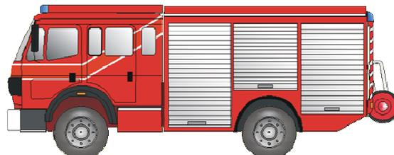
Löschgruppenfahrzeuge besitzen eine vom Fahrzeugmotor angetriebene Feuerlöschkreiselpumpe, einen fest eingebauten Löschwasserbehälter und umfangreiche feuerwehrtechnische Beladung.
