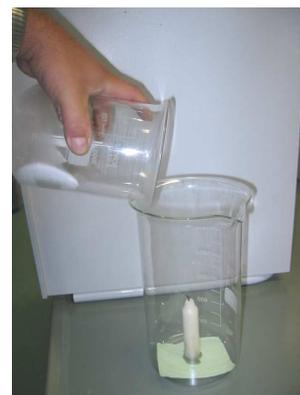
mittels CO<sub>2</sub> gelöschte Kerze im Becherglas
