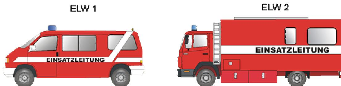
Einsatzleitfahrzeuge sind mit Kommunikationsmitteln und anderer Ausrüstung zur Führung taktischer Einheiten ausgestattet. Neben der größeren Ausstattung unterscheidet sich der ELW 2 vom ELW 1 dadurch, dass Führerhaus und Kommunikationsraum getrennt sind.
