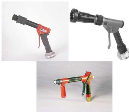
Pistolenstrahlrohre werden überwiegend an Schnellangriffseinrichtungen verwendet. Normaldruck-Strahlrohre besitzen eine C- Kupplung, während Hochdruckstrahlrohre fest mit dem formbeständigen Schlauch verschraubt sind. Das Pistolenstrahlrohr erlaubt die stufenlose Abgabe vom Vollstrahl bis zum feinsten Sprühstrahl. Die abgewinkelte Form des Strahlrohres erfüllt bedingt eine Stützkrümmenfunktion.
