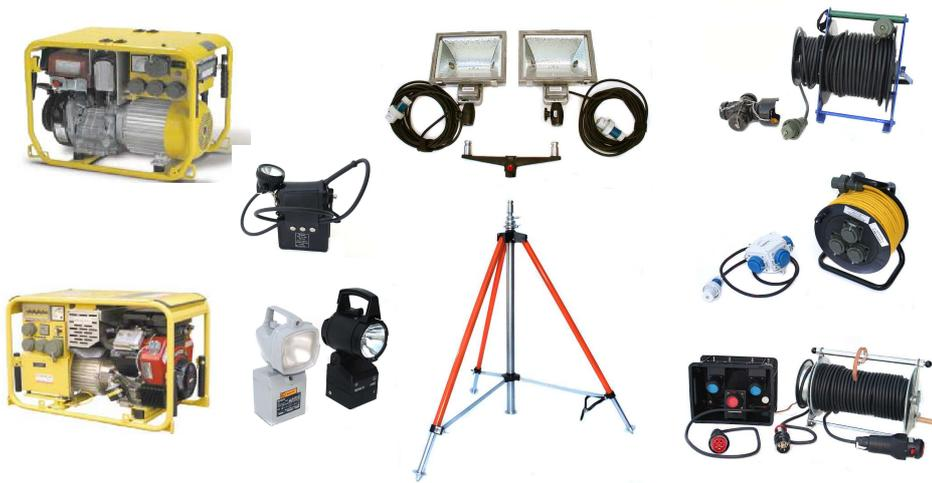
**Stromerzeuger - Aggregate** sind als tragbare Geräte in den Größen 5- und 8 kVA bis 13 kVA genormt. In der Regel verfügen diese über drei 230 V Steckdosen und eine 400 V Steckdose. Als Absicherung bei Fehlerströmen durch Kurzschluss oder defekte Verbraucher ist hierbei das Schutzsystem „Schutztrennung mit Potentialausgleich“ installiert.
