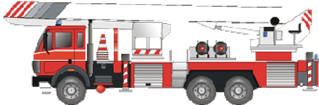
Hubrettungsfahrzeuge sind Fahrzeuge der Feuerwehr, die mit einem maschinell betriebenen Hubrettungssatz ausgerüstet sind. Überwiegend dienen Hubrettungsfahrzeuge zur Rettung von Menschen aus größeren Höhen. Des Weiteren werden diese Fahrzeuge auch zur Brandbekämpfung und technischen Hilfeleistung eingesetzt.
