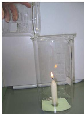
Löschmittel CO<sub>2</sub> wird eingefüllt
