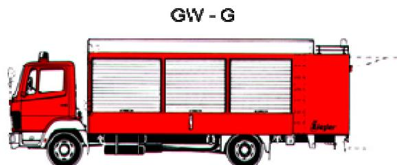
Die Gerätfahrzeuge Gefahrgut sind mit unterschiedlicher Ausrüstung für die Bekämpfung von Unfällen und Schäden in Verbindung mit atomaren, biologischen und chemischen Stoffen ausgestattet. Die Fahrzeuge stellen überwiegend die Einsatzmittel der Facheinheit „Gefahrstoffzug“ dar, der nach den unaufschiebbaren Erstmaßnahmen beim Gefahrguteinsatz tätig wird.
