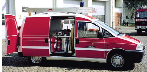
Der Gerätewagen – Tragkraftspritze dient vornehmlich zur Bekämpfung von Kleinbränden und ist eine Alternative zum Tragkraftspritzenanhänger. Es ist nur ein serienmäßiger Kastenwagen zulässig.
