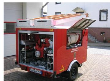
Der Tragkraftspritzen-Anhänger dient vornehmlich zur Bekämpfung von Kleinbränden und ist ein besonders gestalteter, zur Aufnahme einer Tragkraftspritze (TS 8/8 bzw. PFPN 10-1000) und der zugehörigen feuerwehrtechnischen Beladung eingerichteter, einachsiger Feuerwehranhänger.
