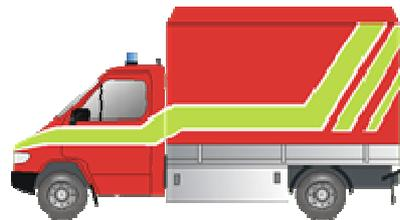
Nachschubfahrzeuge dienen dem Nachführen von Ausrüstung, Geräten, Löschmitteln und sonstigen Gütern zur Versorgung der eingesetzten Einheit. Je nach örtlichen Verhältnissen sind die Feuerwehren mit den unterschiedlichsten Fahrzeugen, Anhängern, Kleincontainern oder Absetzbehältern ausgestattet.
